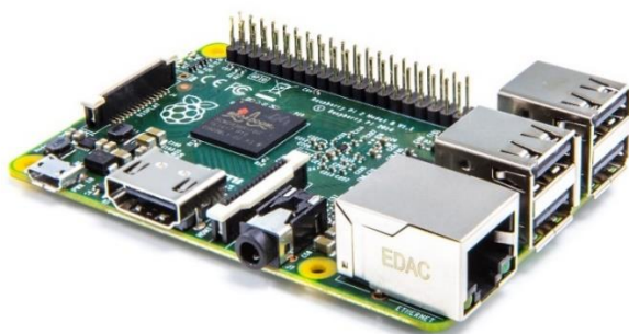
Ryc. 9.2. Mikrokomputer Raspberry Pi 3. Wielkość całego urządzenia jest zbliżona do karty kredytowej (!).
